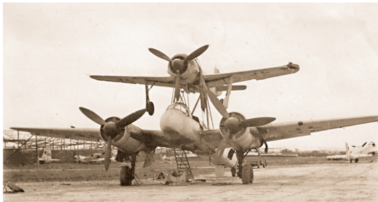
Немецкий авиокомплекс «Мистел», предназначенный для разрушения крупных промышленных объектов
