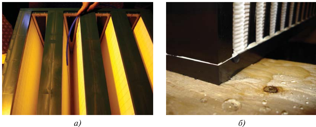
Рис. 3.96. Тестирование шведского фильтра С: а) подача воды; б) течь воды
