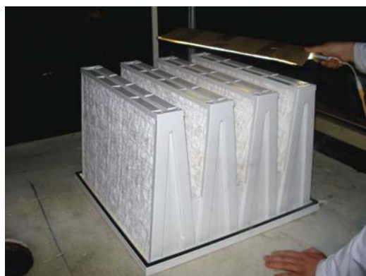
Рис. 4.33. Тестирование фильтра E11–31/38 масляной нитью
