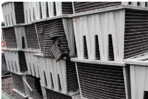
Рис. 3.94. Массовое разрушение фильтров компании E с Mini Pleat
