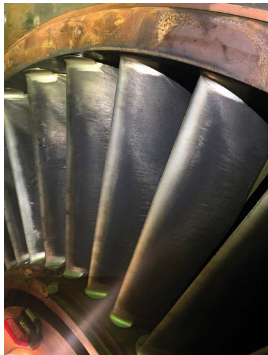
Рис. 2.67. Загрязненные лопатки ВНА ГТУ
