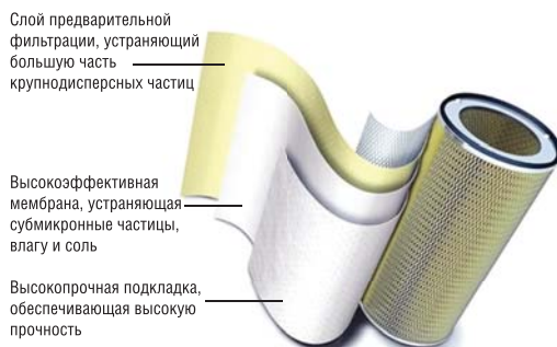
Рис. 3.71. Многослойная конструкция фильтра компании Gore [31]
