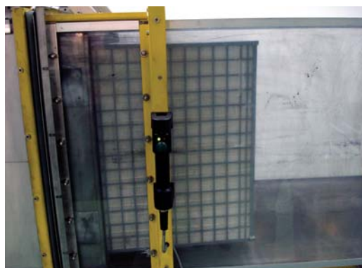
Рис. 4.27. ФТО MVX класса F9 на испытательном стенде
