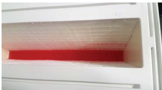
Рис. 3.98. Момент протечки воды из образца М
