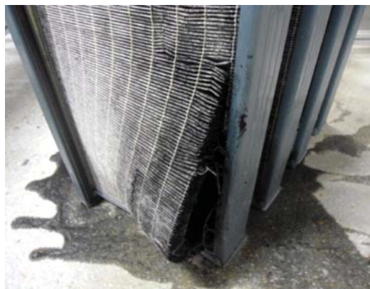
Рис. 3.109. Фильтр тонкой очистки компании E во влажном состоянии после испытания на разрыв
