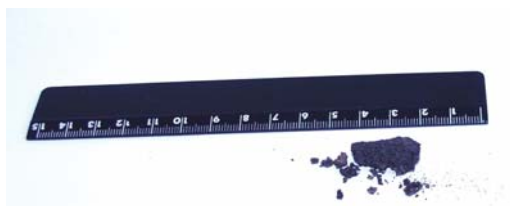
Рис. 2.24. Биомасса насекомых, снятая с лопаток компрессора ГТЭ-20С
