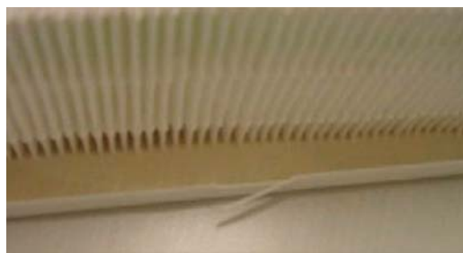
Рис. 4.24. Скол пластмассы рамки фильтра после испытаний в климатической камере
