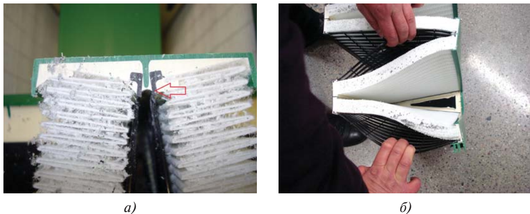
Рис. 3.92. Пластмассовая защитная сетка кассетного фильтра шведской компании С: а) фиксация; б) проверка на прочность
