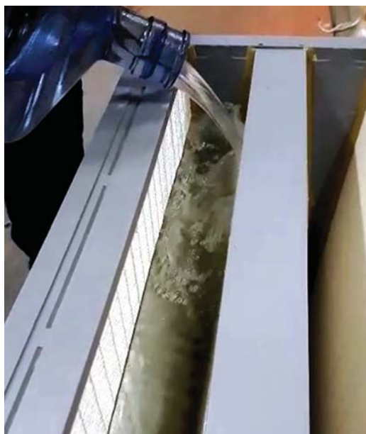
Рис. 4.29. Тест на водостойкость фильтра MVX-F9
