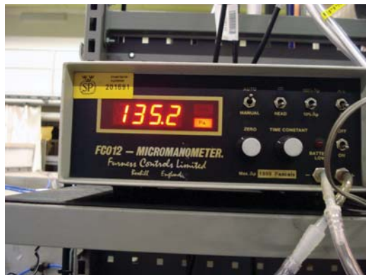
Рис. 4.35. Начальный перепад давления фильтра E10–31/38, зафиксированный во время тестирования
