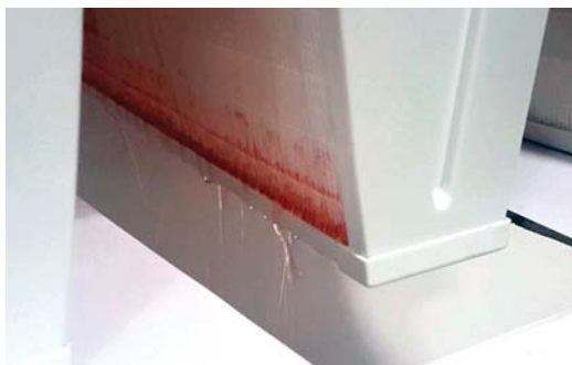
Рис. 3.99. Тестирование образца Е: а) уровень подкрашенной воды; б) течь воды из фильтра
