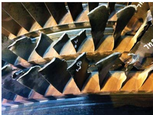
Рис. 3.104. Сломанные лопатки компрессора ГТУ
