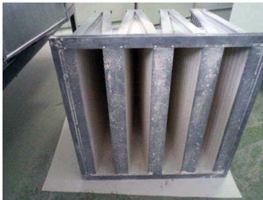
Рис. 4.30. Фильтр MVX–F9 после тестирования на разрыв
