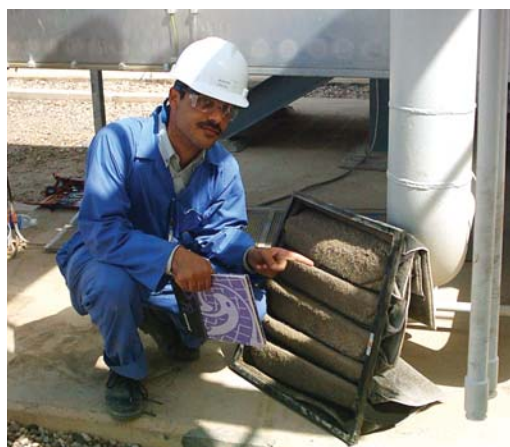
Рис. 3.1. Карманный фильтр заблокирован песком (Ирак) [2]
