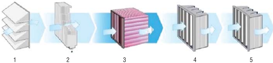
Рис. 3.16. Трехступенчатая система фильтрации циклового воздуха ГТУ: 1 – погодные козырьки, 2 – жалюзийный каплеуловитель, 3 – карманный ФГО/ФСО, 4 и 5 – кассетный ФТО [7]
