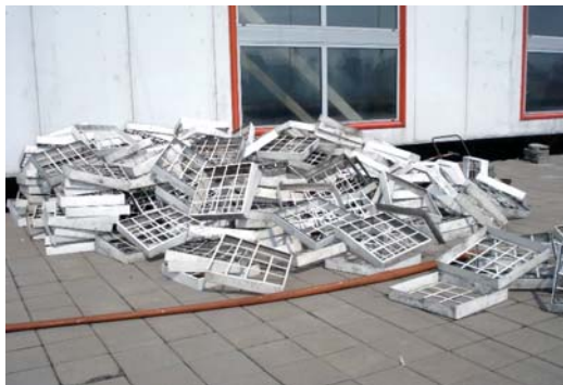
Рис. 3.24. Поврежденные рамки фильтр-коагуляторов Poret
