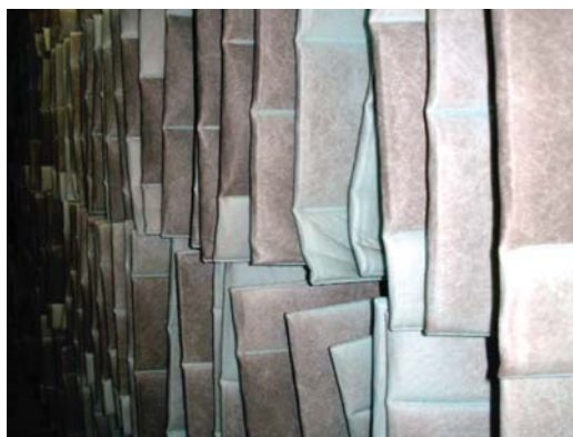
Рис. 3.54. Неравномерное распределение пыли по карманам фильтра компании E
