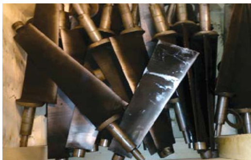
Рис. 3.10. Лопатки ВНА компрессора GE PG935FA Шатурской ГРЭС [6]
