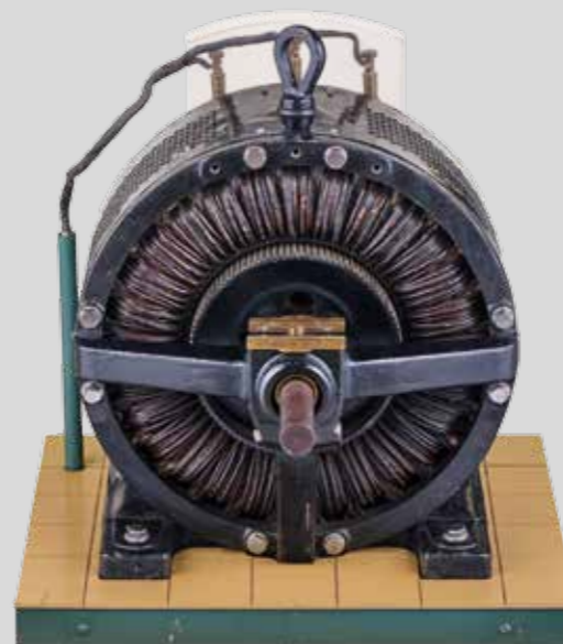
Электродвигатель DR80 конструкции Михаила Доливо-Добровольского
